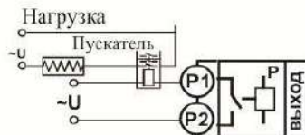
Подключение нагрузки мощностью более 2,3 кВт с помощью электромагнитного пускателя
